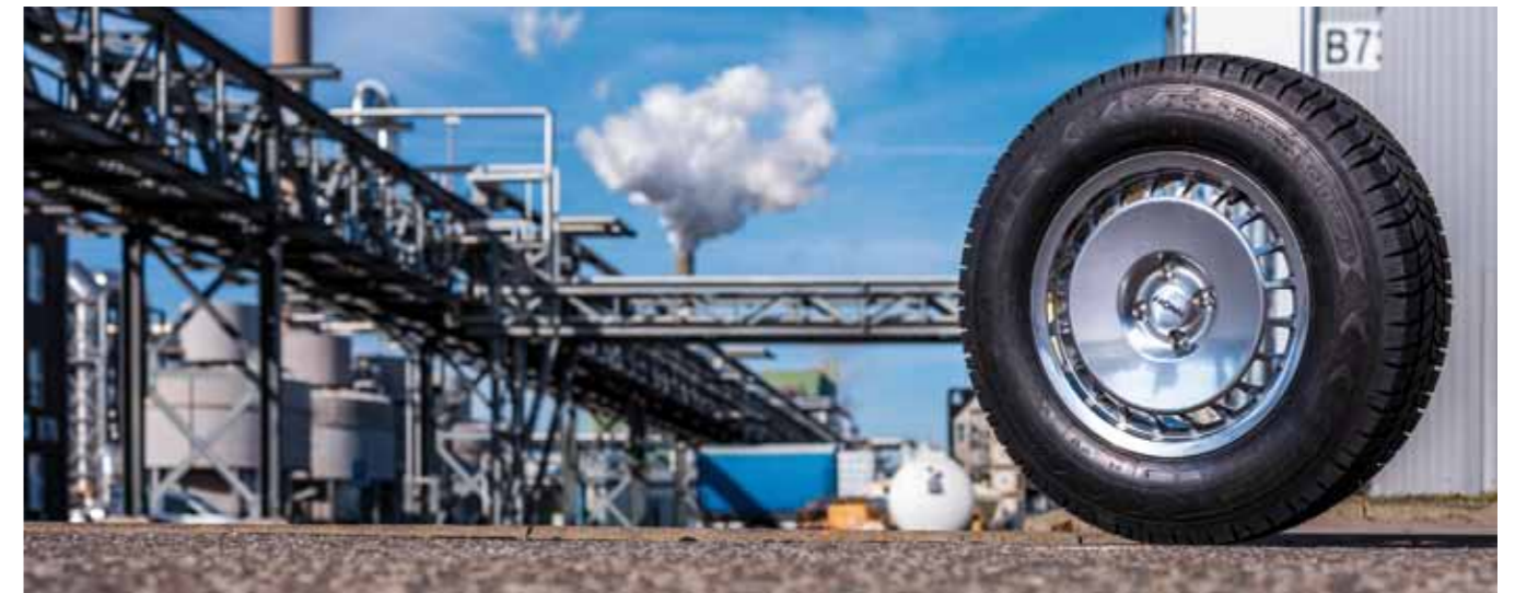
Erste Tests von Reifen mit dem naturidentischen, biomimetischen Synthetikautschuk BISYKA zeigen, dass diese etwa 30 bis 50 Prozent weniger Abrieb im Vergleich zu Naturkautschukreifen erzeugen.
