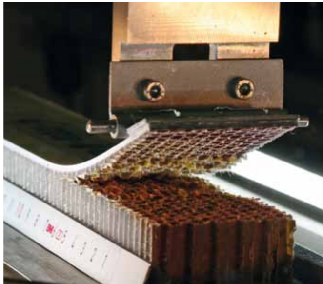
Versuchsaufbau eines Single Cantilever Beam Tests (SCB) einer Wabenkern-Sandwichprobe
